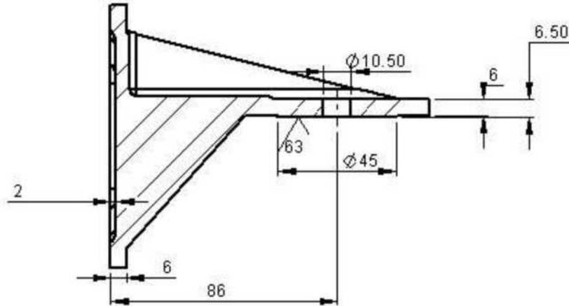
Рисунок 2: Наклонная крепежная база - вид сбоку
