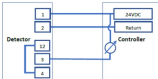
РИСУНОК 7: - 3-проводная схема поглотителя (Sink)
