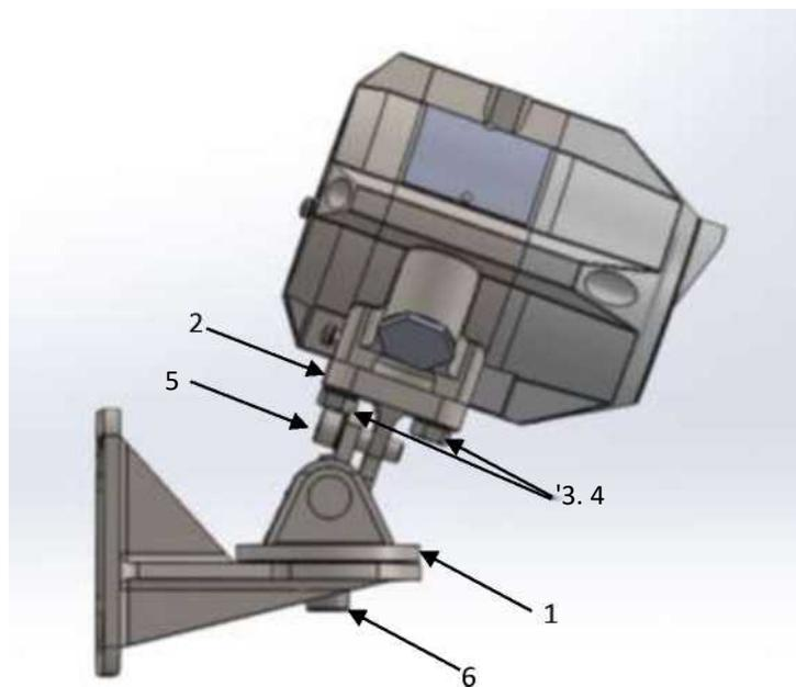
Рисунок 3: Извещатель на наклонном крепеже - вид сбоку
